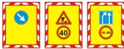
Panouri pentru semnalizare a unui utilaj care se deplasează lucrînd Щиты для обозначения машины, перемещающейся при производстве работ
