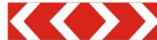
1.33 Direcția curbelor periculoase la stînga și la dreapta Направление опасных поворотов налево и направо
